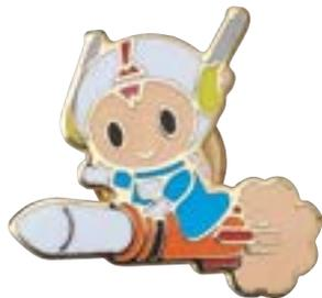
金属板をプレス加工して硬質の塗料で埋めた後、200~300℃で焼き付け、表面を研磨して高級感を出します。また、印刷と併用できるのも大きな特徴です。※オフセットはできません。色入れをする際はDIC・PANTONEで色指示をすることができます。
